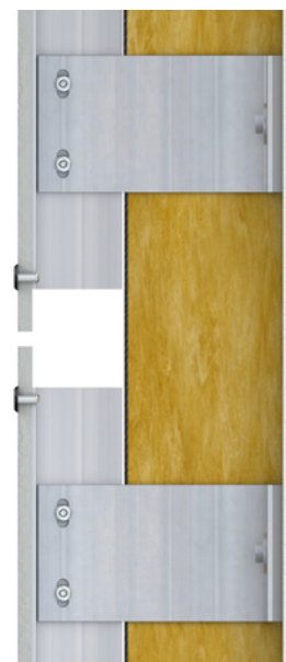
Profilstød = åbent pladestød/pladesamling
