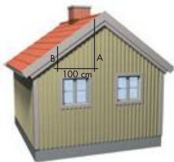
Figur 1. Mål A minus B er grundlag for bestemmelse af tagets hældning. Se tabel 1.
